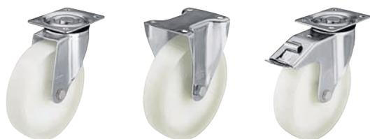
**Кронштейны:** серии L/B - изготовлены методом штамповки из листовой стали, поворотный узел на двухрядном шарикоподшипнике, с прочным центральным стержнем (Ø колеса 150-200 мм), снабжён уплотнением, спрессован специальным, разработанным Blickle, динамическим методом, обеспечивающим путём холодной пластической деформации дорожек качения долговечность, минимальный люфт и лёгкость вращения. Ось колеса на болту.
