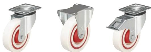
**Кронштейны:** серии LK/BK/ВН - изготовлены методом штамповки из толстостенной листовой стали, поворотный узел на двухрядном шарикоподшипнике, снабжён уплотнением, спрессован специальным, разработанным Blickle, динамическим методом, обеспечивающим путём холодной пластической деформации дорожек качения долговечность, минимальный люфт и лёгкость вращения.
