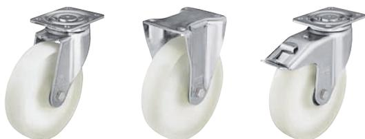
**Кронштейны:** серии LH/VH - изготовлены методом штамповки из толстостенной листовой стали, с массивной вилкой и крепёжной панелью, стянуты очень стабильным центральным болтом с застопоренной гайкой, поворотный узел на двухрядном шарикоподшипнике, усиленном дополнительно **четырьмя закалёнными вкладышами особой формы**, обеспечивающими особо высокую устойчивость к толчкам и ударам.
