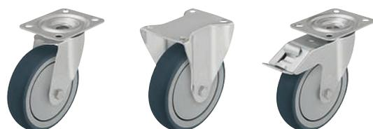
**Кронштейны:** серии LE/B - изготовлены методом штамповки из листовой стали, поворотный узел на двухрядном шарикоподшипнике, снабжён уплотнением, спрессован специальным, разработанным Blickle, динамическим методом, обеспечивающим путём холодной пластической деформации дорожек качения долговечность, минимальный люфт и лёгкость вращения. Ось колеса на болту. Гальванически оцинкованы с голубой пассивацией без содержания Cr6+.
